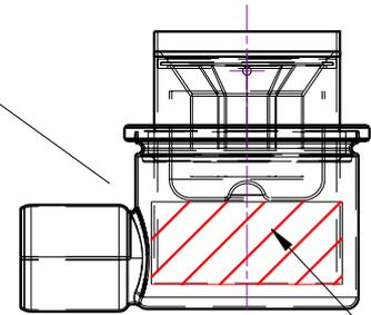
Stutzen im schraffierten Bereich auf OK horizontalen Auslauf kürzen damit der Abfluss nicht behindert wird!!
