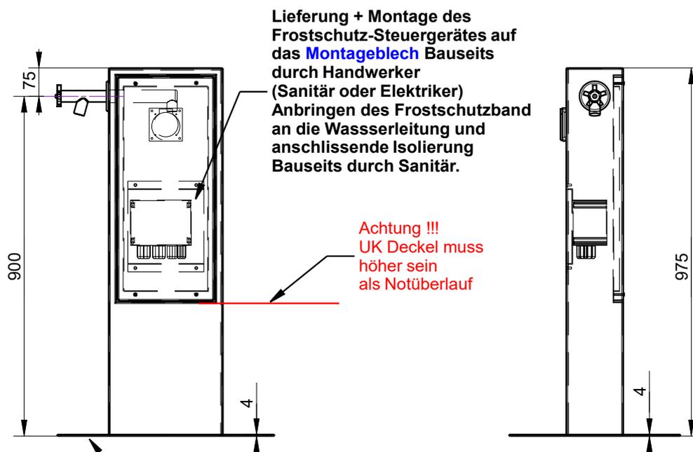
Klebeblech unten zur besseren Haftung vollflächig mit Haftkleber zusätzlich zu den Schrauben befestigen.
