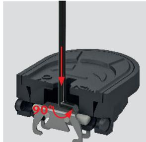
Rosthaken hinuntergedrückt halten und um 90° drehen, sodass der Rosthaken in der Composite-Kunststoffabdeckung arretiert ist.
