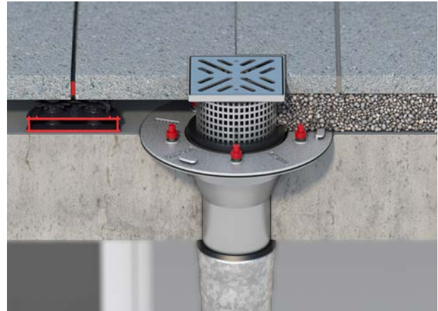
Balkonablauf mit Pressdichtungsflansch für den Einbau in eine Balkonplatte mit Abdichtungsbahn und zusätzlicher Belagsoberfläche
