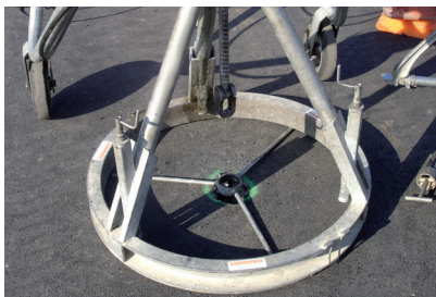
Pickelloch freilegen, Hebegerät einmitten
