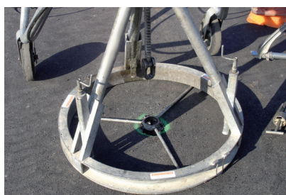
Liberare il foro per il piccone, centrare l'apparecchio di sollevamento
