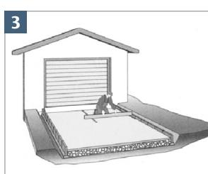
3) Uno strato di livellamento di circa 4 cm di spessore viene applicato alla sottostruttura come sottofondo di sabbia o di una miscela di compost setacciato con sabbia/lava (rapporto 50/50) e lisciato.
