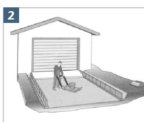
2) Dopo l'indurimento della delimitazione dei bordi, la base scavata viene compattata meccanicamente, ad esempio con un vibratore. Installare e vibrare lo strato di base, ad esempio composto da ghiaia/pietra frantumata 2/32-2/45.
