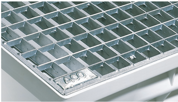
Griglia a maglie, dimensione delle maglie 30 x 30 mm, calpestabile fino a 1,5 kN
