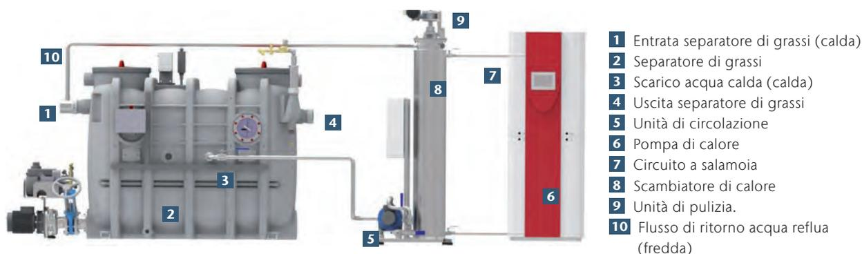
L'acqua reflua calda generata dal funzionamento della cucina entra nel separatore di grassi (2) attraverso l'entrata (1). Questa acqua reflua viene poi estratta dal separatore di grassi tramite l'unità di circolazione (5) attraverso il manico di collegamento (3) applicato sul separatore di grassi. In seguito, l'acqua reflua, inizialmente ancora calda, fluisce nello scambiatore di calore (8), viene raffreddata lì e ritorna infine nel separatore di grassi (10).
