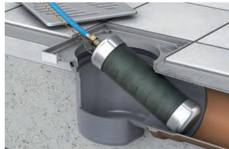
**La prova di funzionamento** dell'elemento antirigurgito viene effettuata nello stato smontato. Per la prova, versare acqua chiara nell'imbuto fino a raggiungere 100 mm di colonna d'acqua. Se per mantenere la colonna d'acqua non si devono rabboccare più di 500 ml di acqua pulita entro 10 minuti, la valvola antiriflusso è considerata a tenuta secondo la norma DIN EN 13564.
