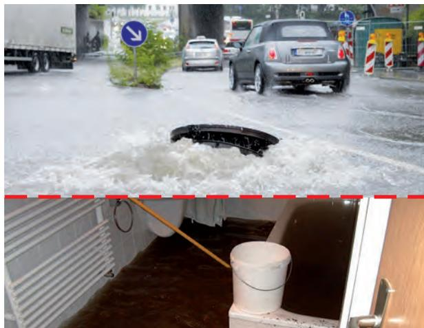
Il livello di riflusso è il livello più alto a cui le acque reflue possono salire nel sistema di drenaggio, che di solito è il bordo superiore della strada. A partire da questa altezza, l'acqua di riflusso si distribuisce sulla superficie del terreno. Il livello di riflusso è definito nelle regole locali
