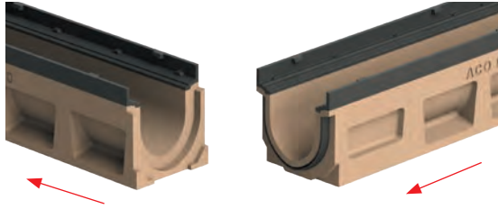
Eckverbindung (90°) über die seitlich geöffnete Vorformung (einseitig) am 0,5 m-Element
