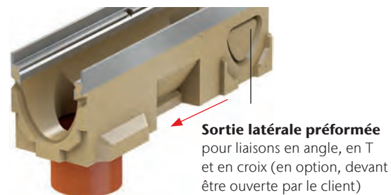
Raccord vertical à la conduite principale par un joint d'étanchéité formé dans la semelle du caniveau (avec l'élément de 0,5 m et de 1,0 m)
