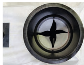
Montage des Zwischenteils (= sanddicht)
