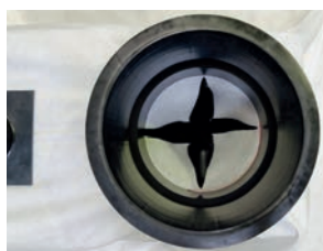
Montaggio dell'elemento centrale (= a tenuta di sabbia)
