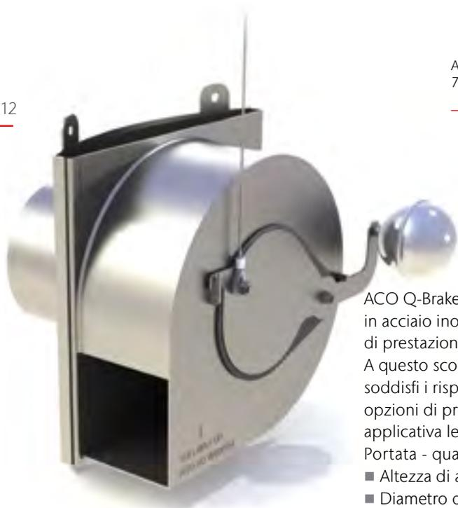
ACO Q-Brake Vortex può essere progettato per scarichi di 1 - 100 l/s. Il prodotto è fabbricato in acciaio inox 1.4301 o 1.4401 e configurato individualmente per soddisfare specifici criteri di prestazione.
