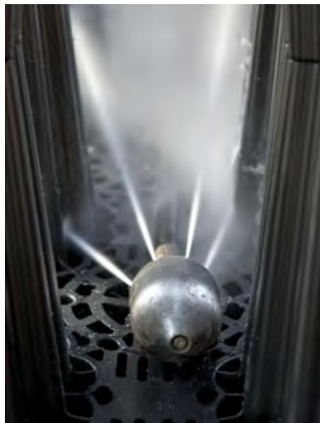
Dispositivo di pulizia con testa di lavaggio. Il lavaggio a pressione e l'aspirazione di eventuali depositi sono possibili contemporaneamente.
