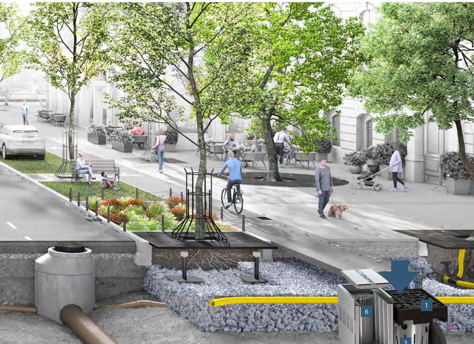
L'acqua piovana contaminata viene convogliata selettivamente nel pozzetto di ingresso del CombiPoint attraverso la griglia di ingresso della città delle spugne (1). La prima pulizia grossolana avviene nella trappola a foglia inserita (2). L'acqua sale poi nella struttura densa del pozzo e le particelle fini possono depositarsi nel serbatoio dei fanghi umidi più basso (3).
