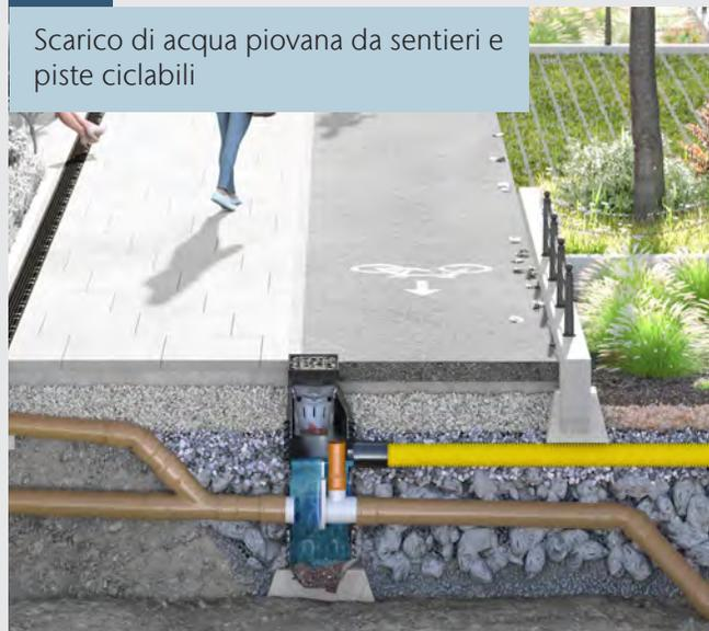
infiltrazione (6) e da qui raggiunge lo strato di distribuzione della città di spugna. Se la città di spugna è satura e c'è un riflusso nel pozzo di ingresso, il raccordo di troppo-pieno (7) impedisce il ritorno in superficie - il bypass conduce direttamente alla fognatura.
