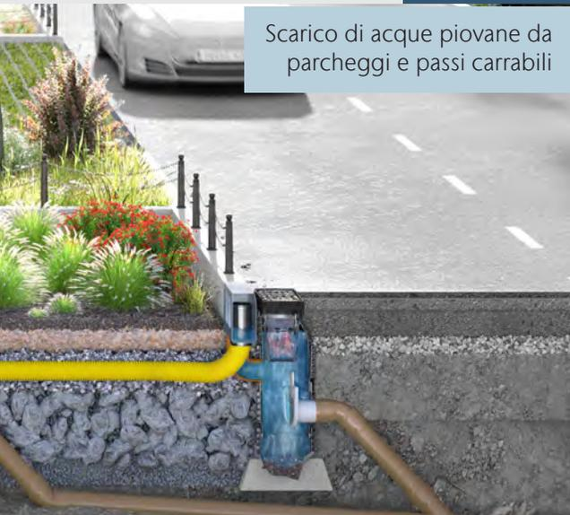
Scarico superficiale delle acque piovane tramite letti profondi (filtro a terra) per parcheggi e vialetti in combinazione con la cassetta di scarico ACO in spugna per città
