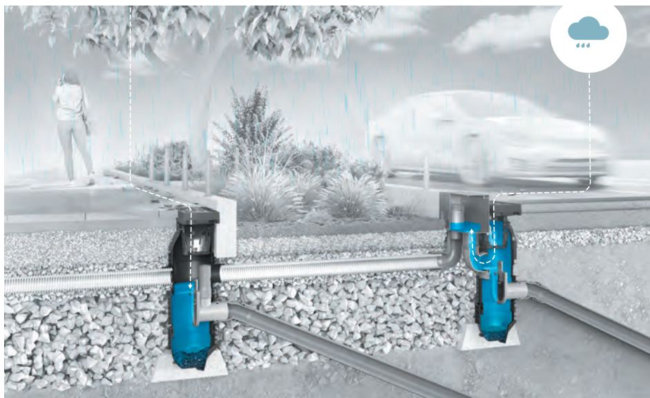
Figura 1: Livello tipico dell'acqua dopo il primo evento di pioggia
