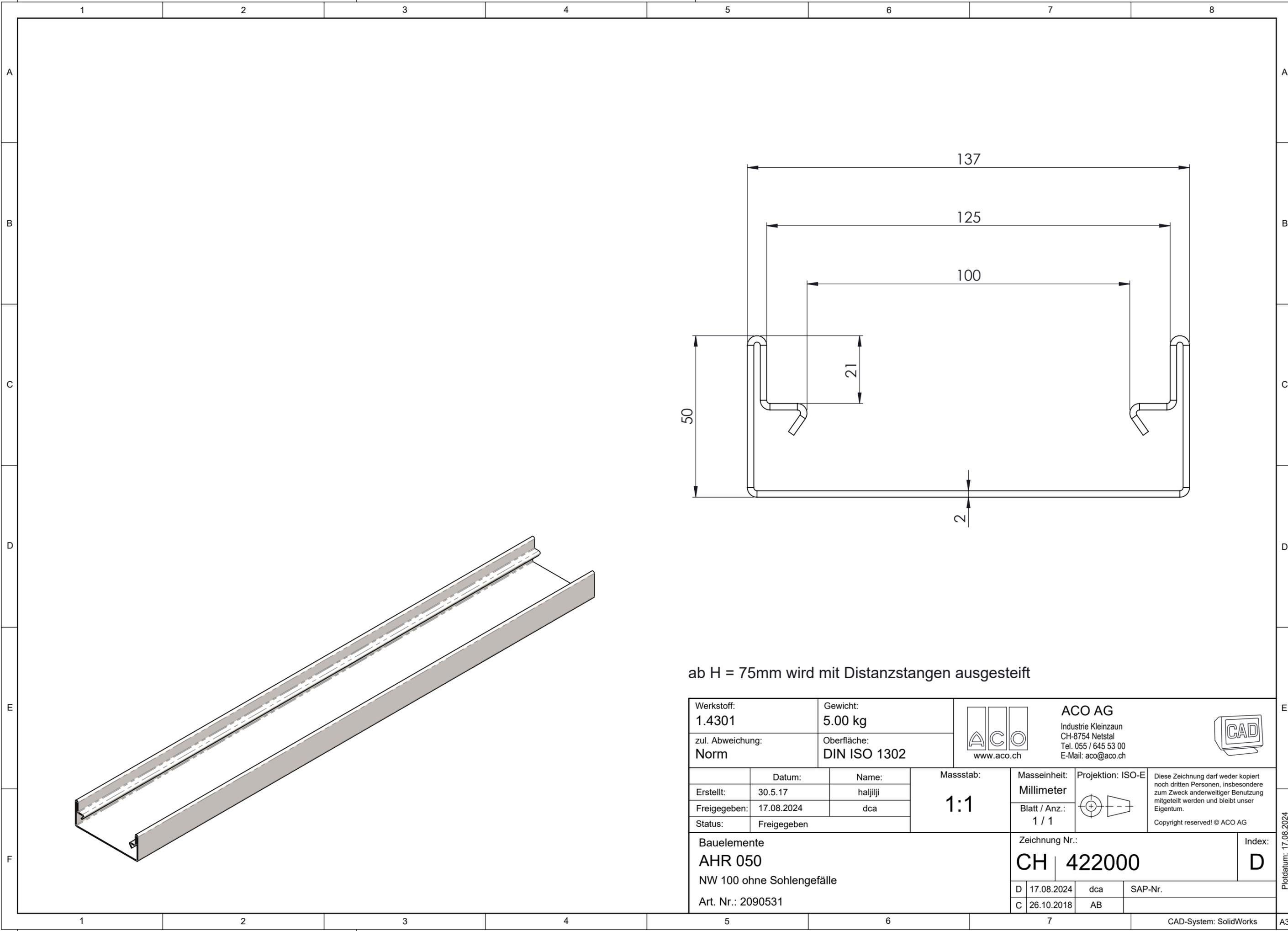
ab H = 75mm wird mit Distanzstangen ausgesteift
