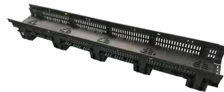
Die ACO Profiline X kann mit zwei bis fünf Höhenversteller ausgerüstet werden. Die Anzahl der Höhenversteller hat wesentlichen Einfluss auf die Tragfähigkeit des Systems.
