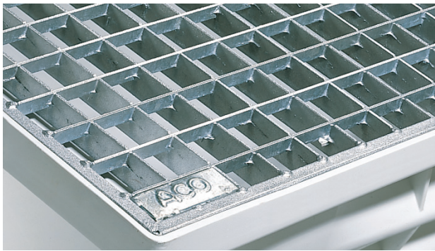
Maschenrost, Maschenweite 30 x 30 mm, begehbar bis 1,5 kN
