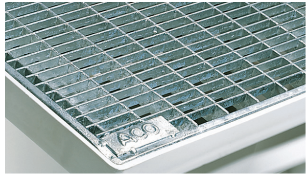
Maschenrost, Maschenweite 30 x 10 mm, begehbar bis 1,5 kN, befahrbar, Radlast bis 9 kN
