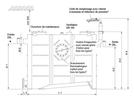
représenté : NS 4, côté de commande à droite, pour le côté de commande à gauche, les composants (hublot) sont disposés de manière inversée par rapport à l'axe central du séparateur.
