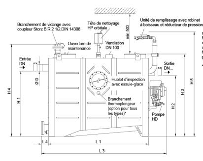
représentée : NS 4, côté de commande à droite, pour le côté de commande à gauche, les composants (raccord d'évacuation, hublot) sont disposés de manière inversée par rapport à l'axe central du séparateur.
