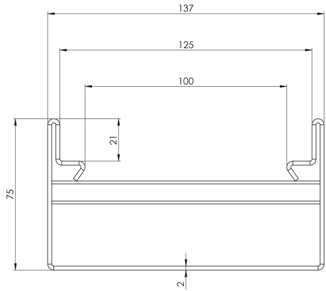
ab H = 75mm wird mit Distanzstangen ausgesteift
