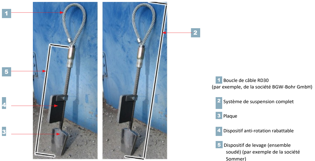
Fig. 1 Montage du dispositif de suspension
