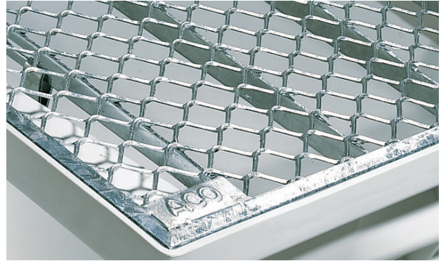
Grille en métal déployé, acier galvanisé, praticable jusqu'à 1,5 kN
