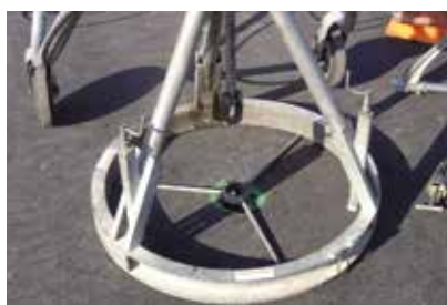
Dégager le trou de pic, centrer l'appareil
