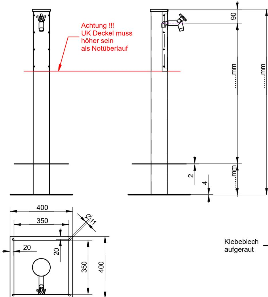
Die Entleerung der Wasserzuleitung muss bauseits sichergestellt werden!
