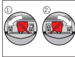
Lässt sich der Notverschluss nicht einwandfrei und leicht betätigen, Rückstaeinheit ausbauen, reinigen und einfetten. Häufig sind grobe Ablagerungen die Ursache.
