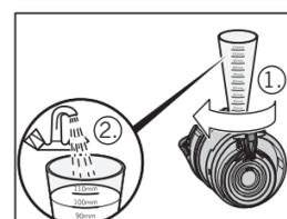
Die Rückstaeinheit gilt als ausreichend dicht, wenn innerhalb von 10 Minuten weniger als 500 ml (0,5 l) Wasser nachgefüllt werden muss.
