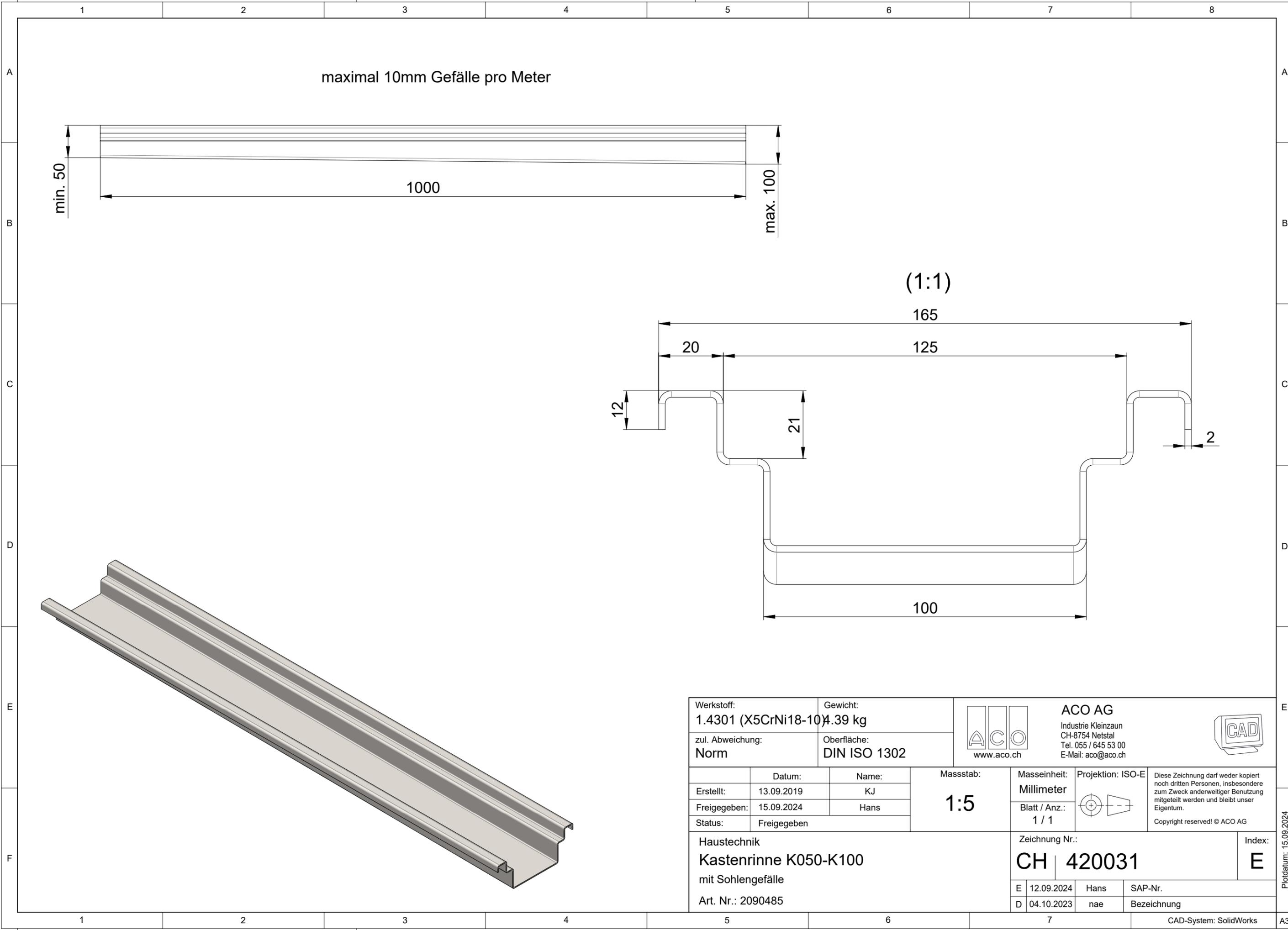
maximal 10mm Gefälle pro Meter
