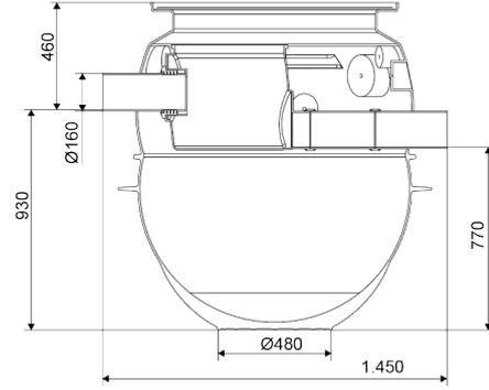
Unità di collegamento per separatore
