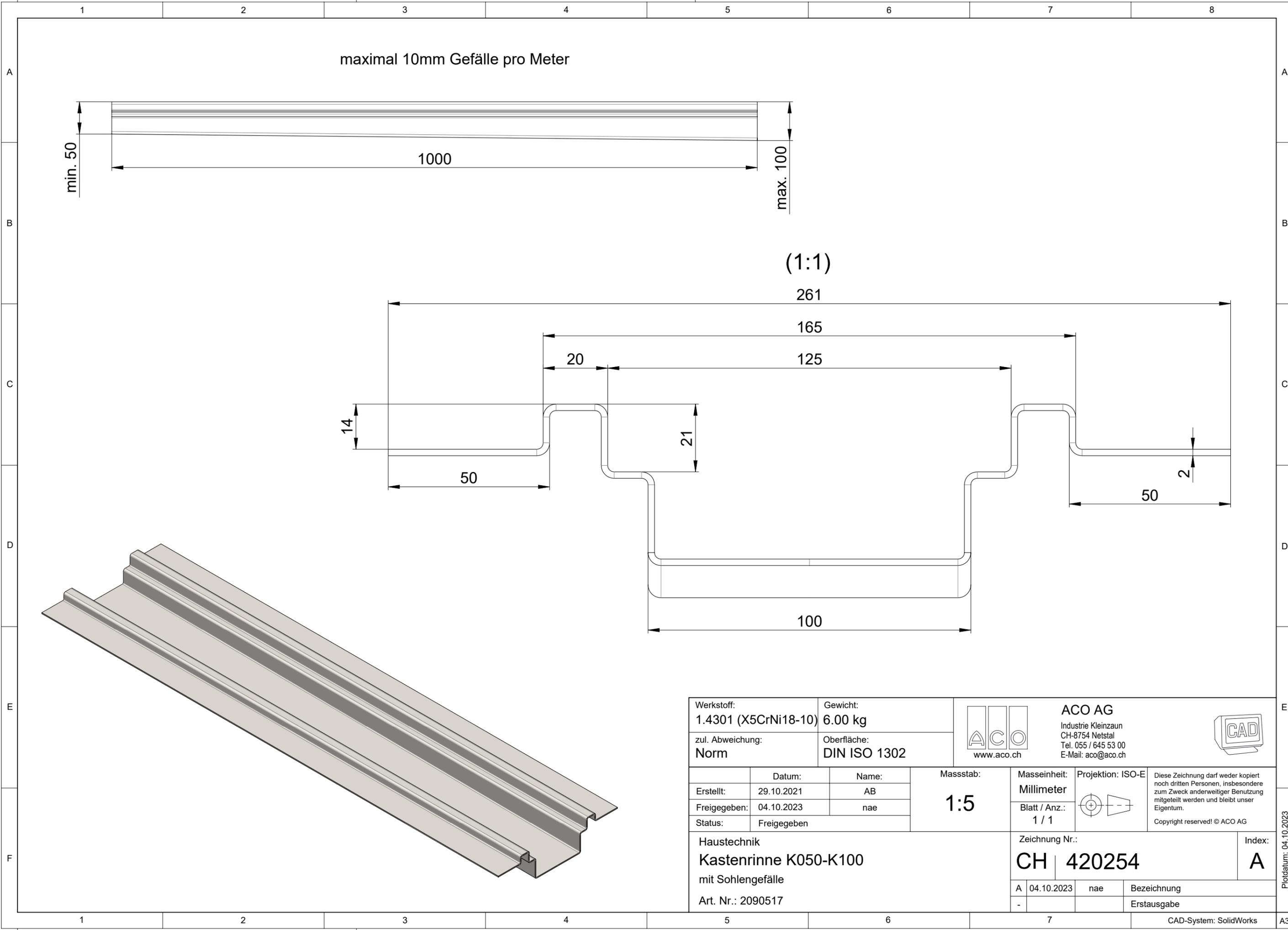
maximal 10mm Gefälle pro Meter
