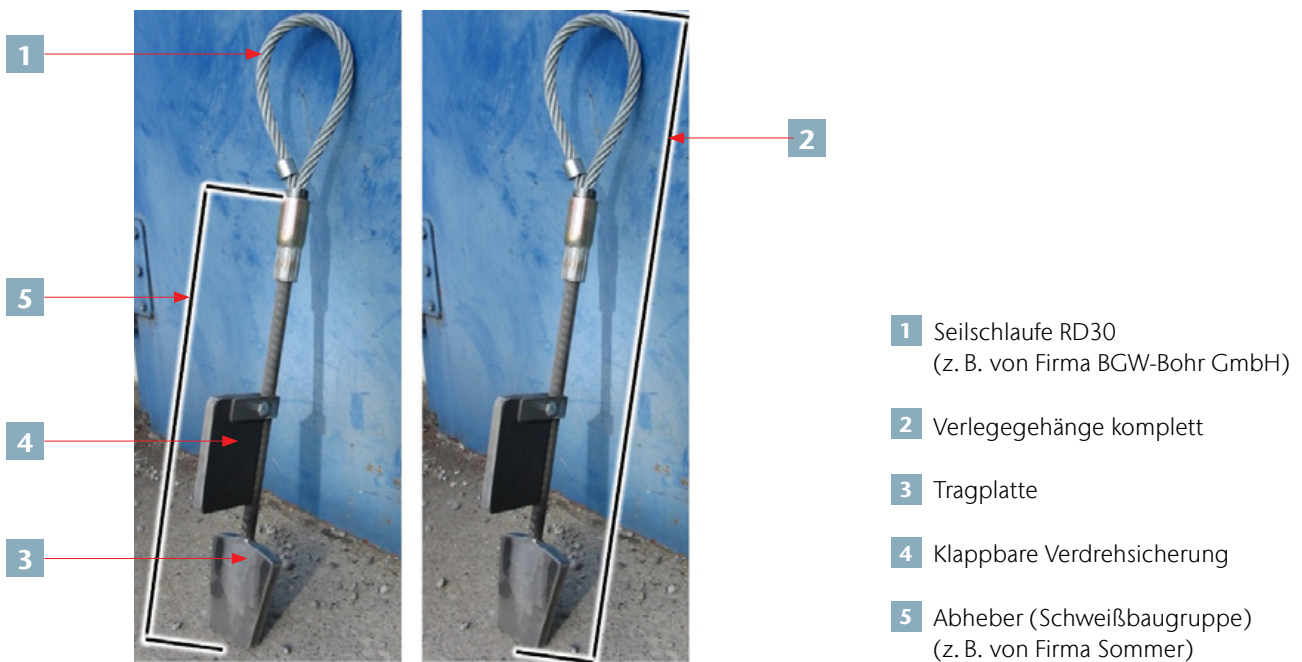
Abb. 1 Aufbau Verlegegehänge
