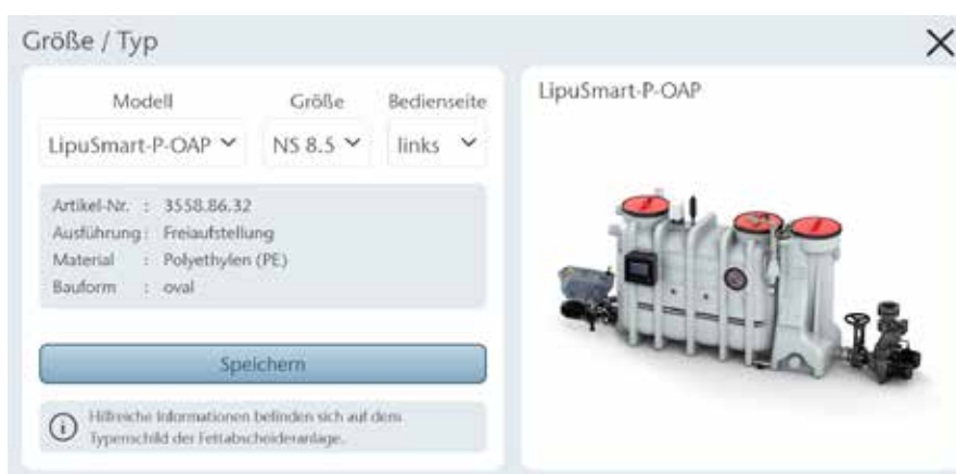
Abbildung: Auswahl der installierten Fettabscheideranlage
