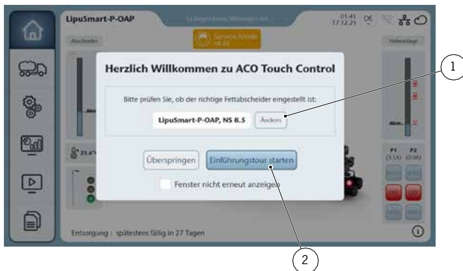
Figura: Display durante la messa in funzione iniziale
