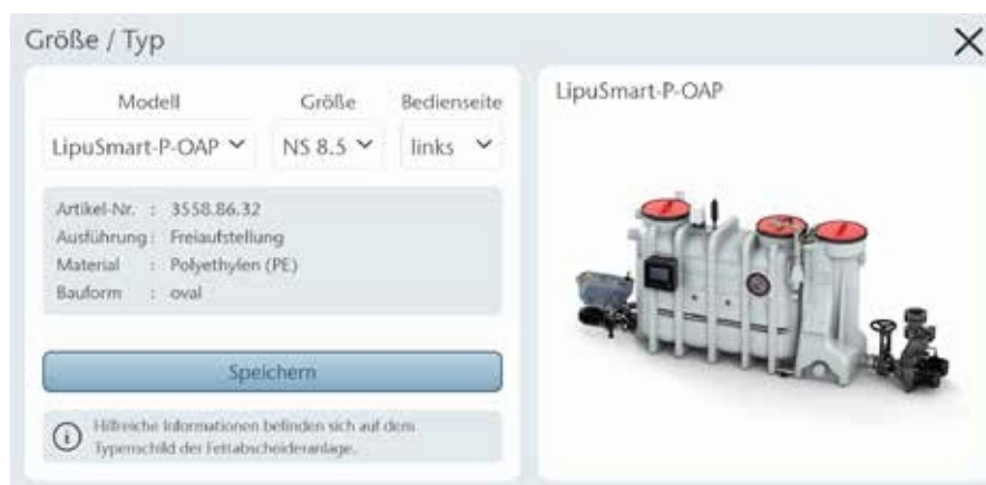
Figura: Selezione del sistema separatore di grassi installato
