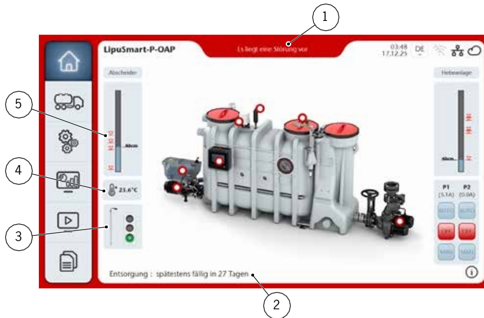
Figura: Indicatore di stato del separatore di grassi
