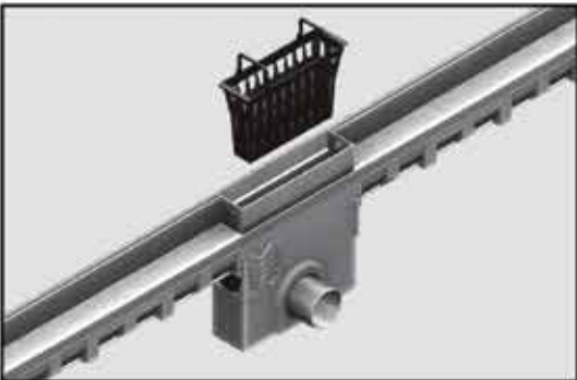
Fase 3: Prelevare il recipiente del fango dalla cassetta e pulirlo.
