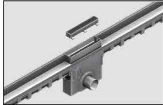
Fase 2: Togliere l'appoggio per superficie a scelta o griglia dell'elemento di servizio.
