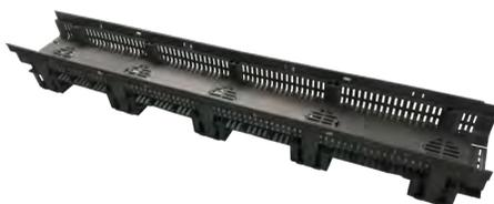
ACO Profiline X può essere dotato di due o cinque regolatori di altezza. Il numero di regolatori di altezza influisce notevolmente sulla capacità di carico del sistema.
